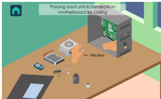
Gambar 19. Tahapan Memasang Baut pada Motherboard
