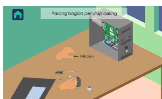
Gambar 23. Tahapan Memasang Penutup Casing
